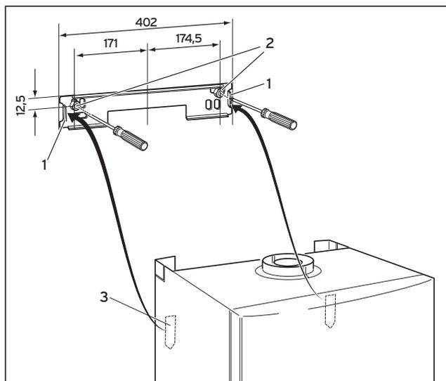
Fig. 3.6 Montaggio dell'apparecchio
