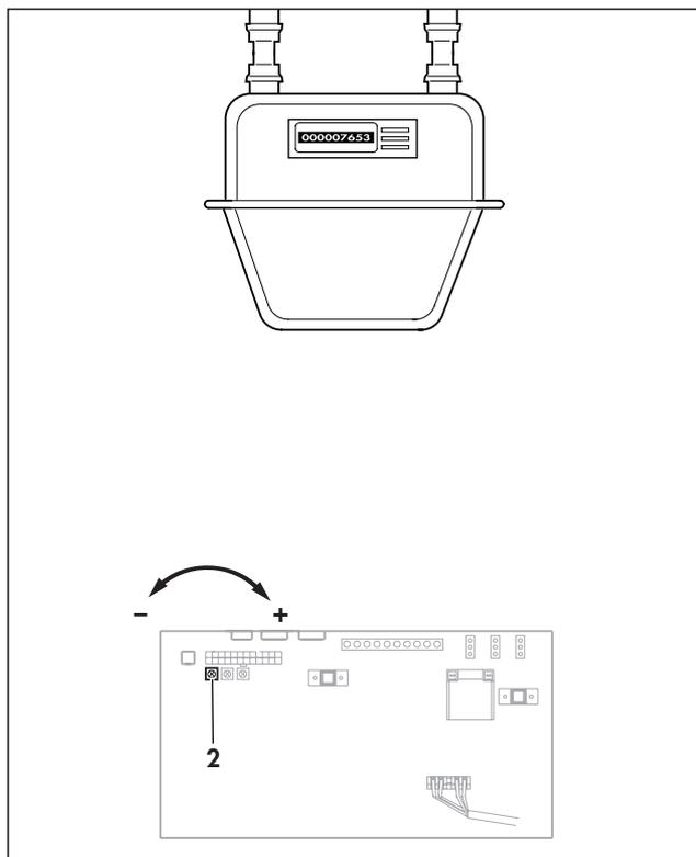
Fig. 4.6: Controllo e impostazione del carico parziale di riscaldamento mediante metodo volumetrico.
