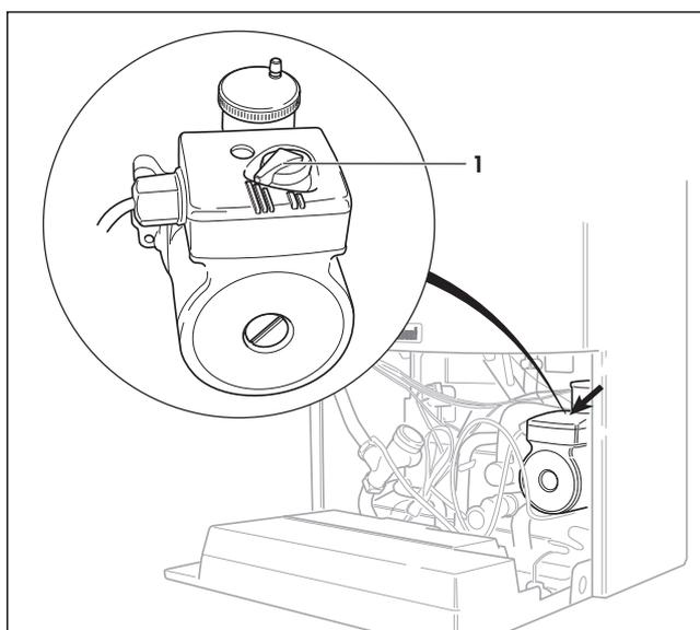
**Fig. 6.3: Commutatore velocità della pompa**
