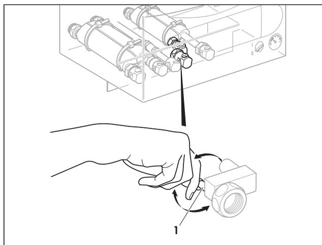
**Fig. 6.5: Impostazione quantità di acqua calda**
