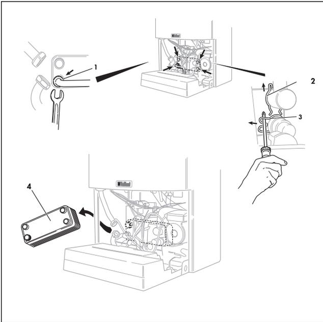
**Fig. 7.2: Decalcificazione dello scambiatore di calore secondario**
