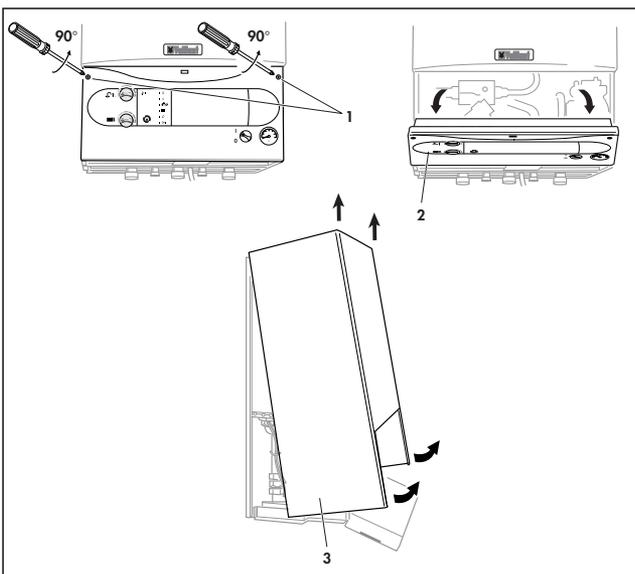
Fig. 3.16 Smontaggio del rivestimento dell'apparecchio
