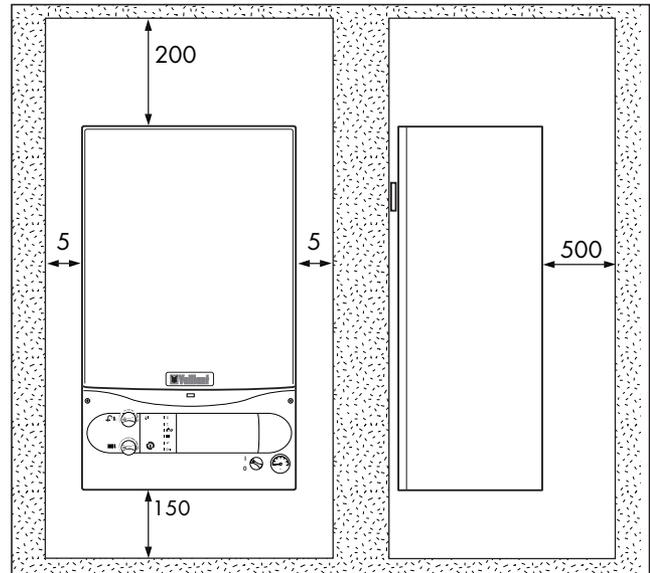
Fig. 3.3 Distanze minime per installazione e manutenzione
