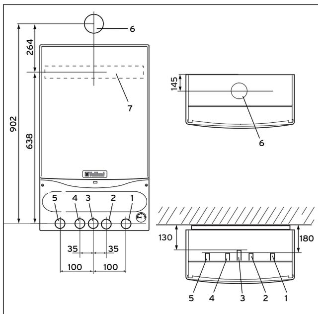
Fig. 3.5 Posizione e distanze raccordi idraulici
