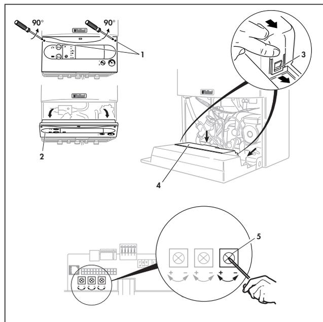
Fig. 6.1: Impostazione del tempo di post-funzionamento della pompa
