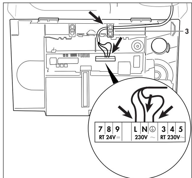
Fig. 3.12 Conduzione del cavo
