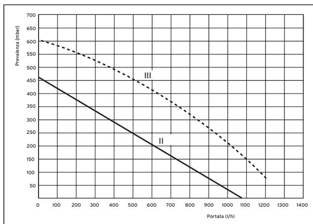
**Fig. 6.4: Curve caratteristiche della pompa**
