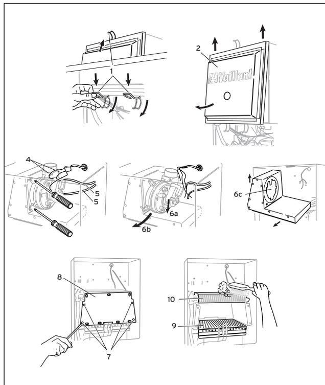
Fig. 7.1: Pulizia del bruciatore e dello scambiatore di calore primario
