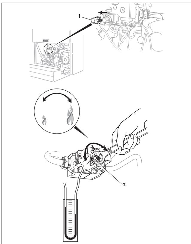
Fig. 4.3 Impostazione del carico termico massimo (carico nominale)
