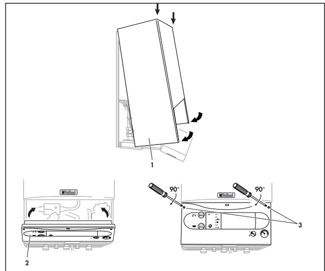
Fig. 3.17 Montaggio del rivestimento dell'apparecchio
