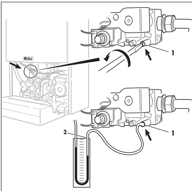
Fig. 4.1: Controllo della pressione dinamica a monte dell'apparecchio
