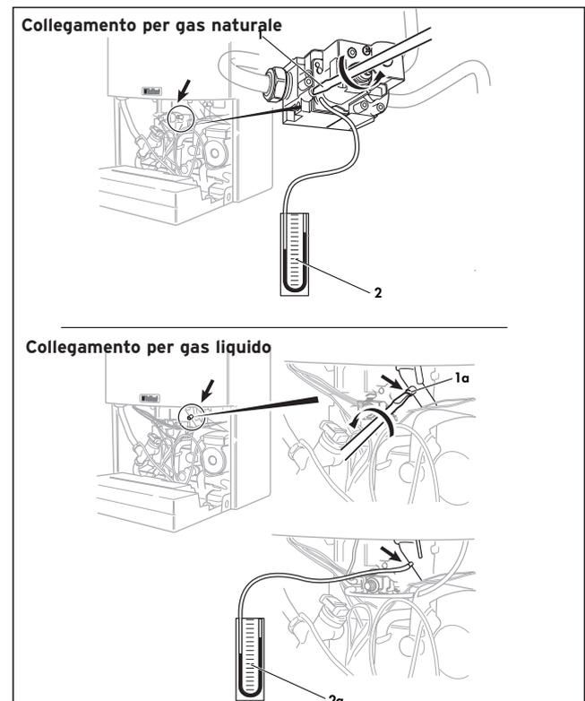
Fig. 4.2: Applicazione di un manometro ad U
