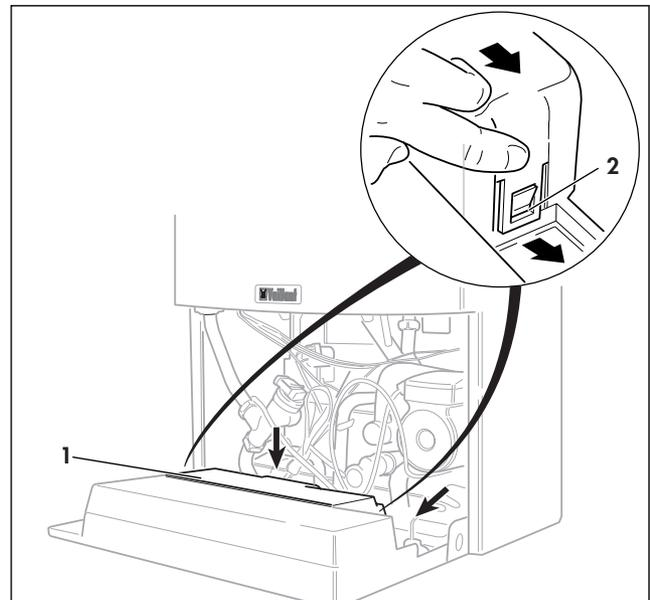
Fig. 3.11 Accesso alla morsettiera di collegamento
