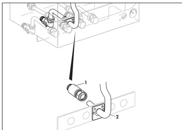
Fig. 3.7 Montaggio del raccordo gas
