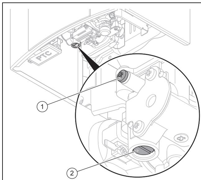
1. Ruotare il selettore di temperatura fino al finecorsa in senso orario per ridurre la quantità d'acqua e impostare la massima temperatura dell'acqua.
