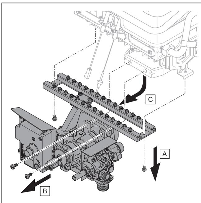
7. Estrarre l'elettrodo di accensione e quello di rilevazione collegati all'alloggiamento della scheda di comando.
