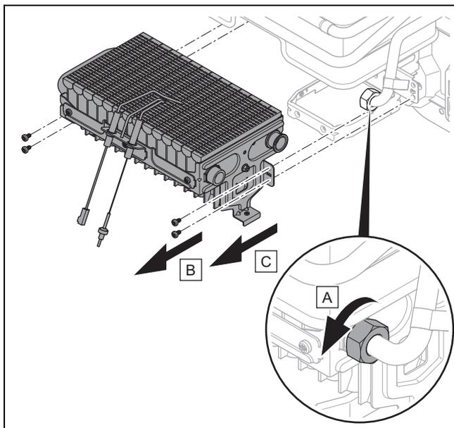
11. Svitare il dado a risvolto del raccordo dell'acqua calda dello scambiatore di calore sul bruciatore.
