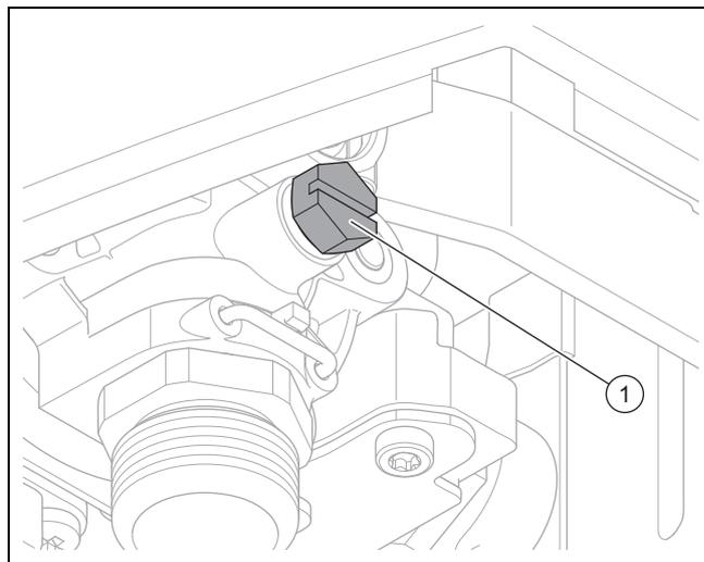
1. Allentare la vite di scarico **(1)** e l'anello di tenuta per lo scarico.
