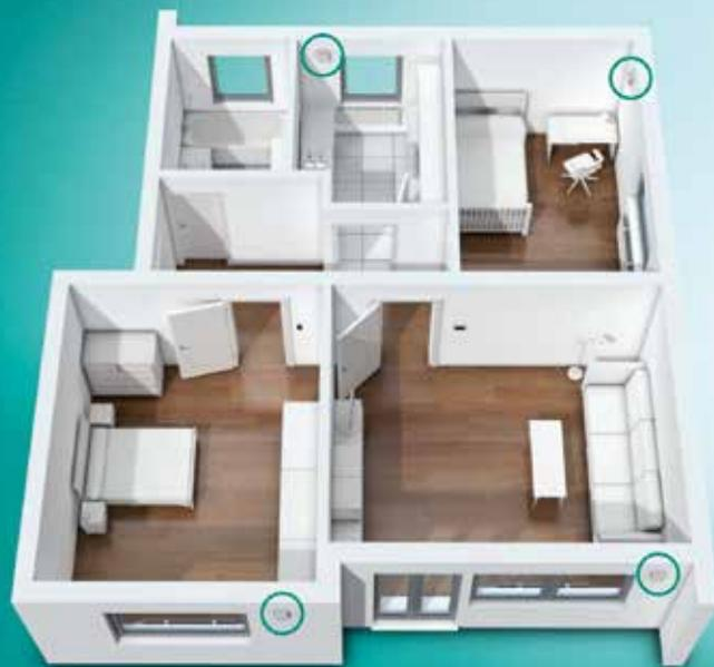
Modulare e di facile installazione, **recoVAIR 60/2** si integra facilmente all'interno degli ambienti domestici. Basta un solo foro sulla parete e in pochi minuti è possibile installare un'unità di ventilazione in grado di assicurare un adeguato ricambio d'aria anche per stanze di elevata metratura.
