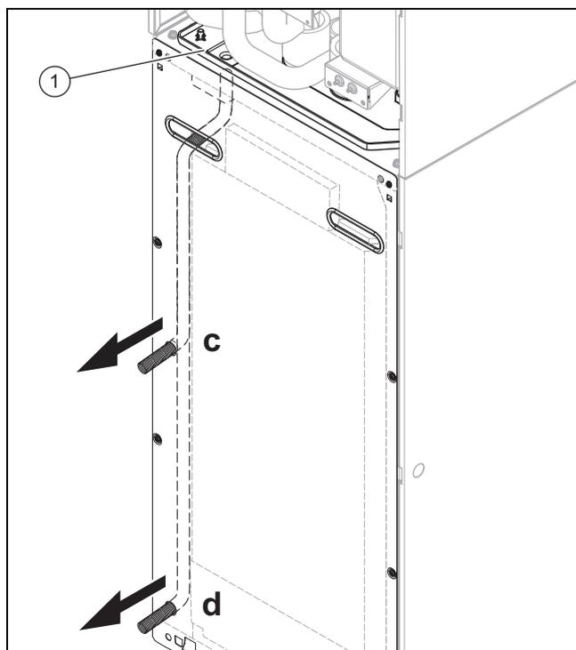
1. Selezionare una delle possibili aperture sul mantello per la tubazione flessibile di scarico della condensa (lunghezza 180 mm) della vaschetta raccogli-condensa (1) e posarvi la tubazione stessa.
