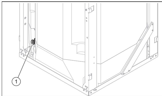
4. Collegare un tubo flessibile al raccordo del rubinetto di scarico (1) e inserire l'estremità libera del tubo flessibile in un punto di scolo adatto.
