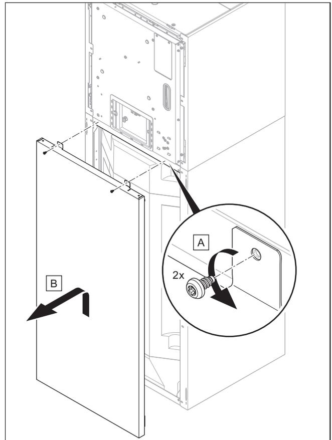
2. Rimuovere entrambe le viti e sollevare la parte inferiore del mantello anteriore e sfilarla in avanti.
