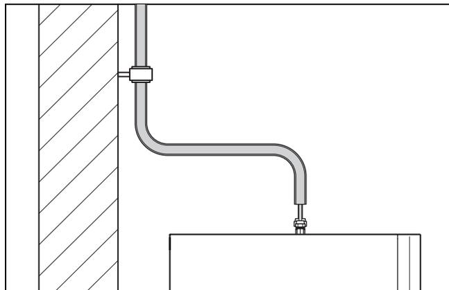
10. Fissare i tubi con fascette a parete insonorizzate (collari per impianti di refrigerazione) sulla parete.
