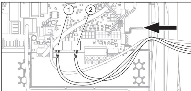
3. Posare il cavo da 24 V per il contatto S20 del termostato limite di sicurezza e il cavo eBUS tramite i fermacavi di destra della scatola della scheda comando.
