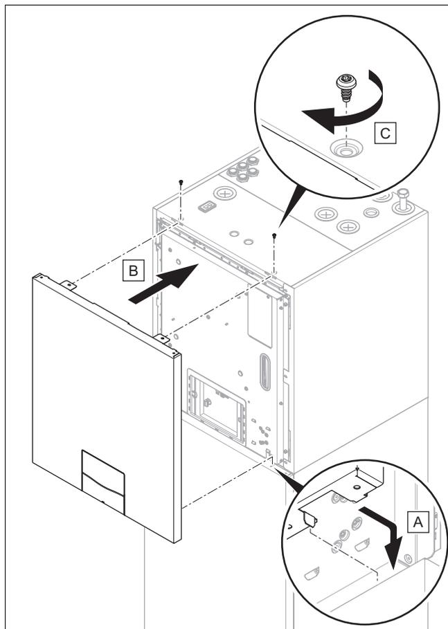
6. Inserire la parte superiore del pannello anteriore e fissarla con le due viti.
