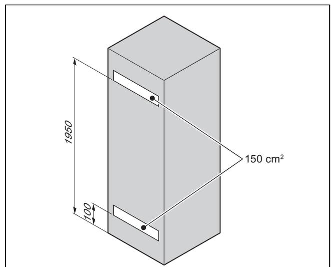
In alternativa: aperture necessarie nell'anta e nel soffitto dell'armadio
