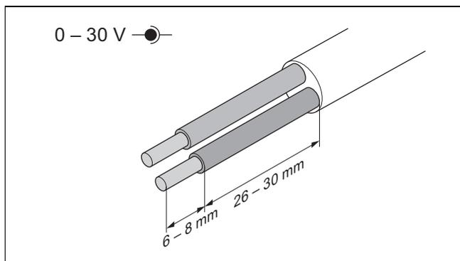
3. Per evitare cortocircuiti nel caso di un distacco indesiderato di un filo, rimuovere l'involucro esterno dei cavi flessibili di non oltre 30 mm.
