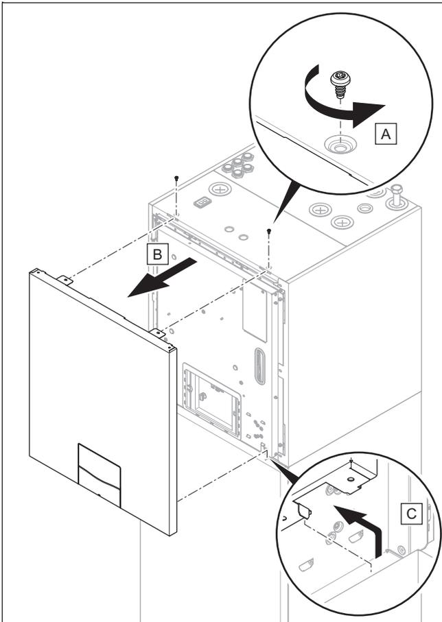
1. Rimuovere le due viti ed estrarre la parte superiore del mantello anteriore tirandola in avanti.
