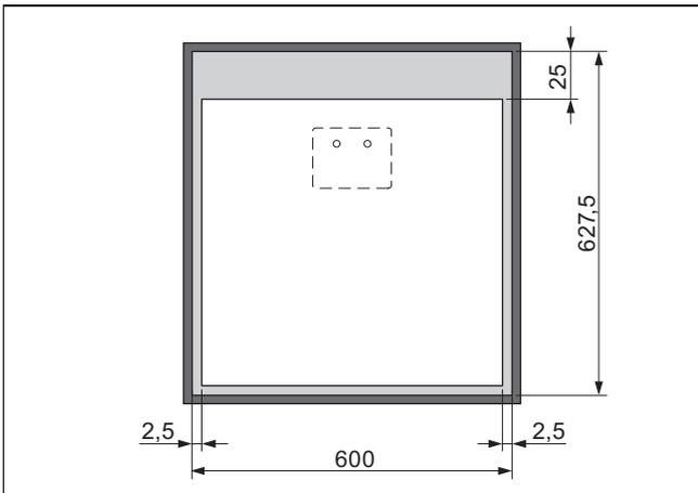
Distanze necessarie in mm con quantità di refrigerante > 1,84 kg
