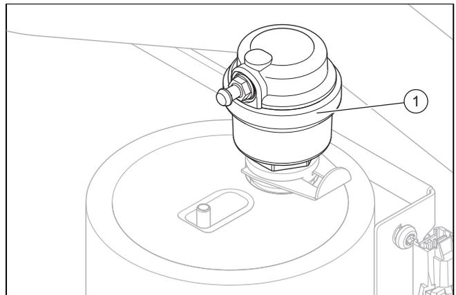
1. Innestare eventualmente un tubo flessibile sul raccordo sul disaeratore rapido interno (1) sopra il riscaldamento elettrico supplementare per scaricare l'acqua che fuoriesce.
