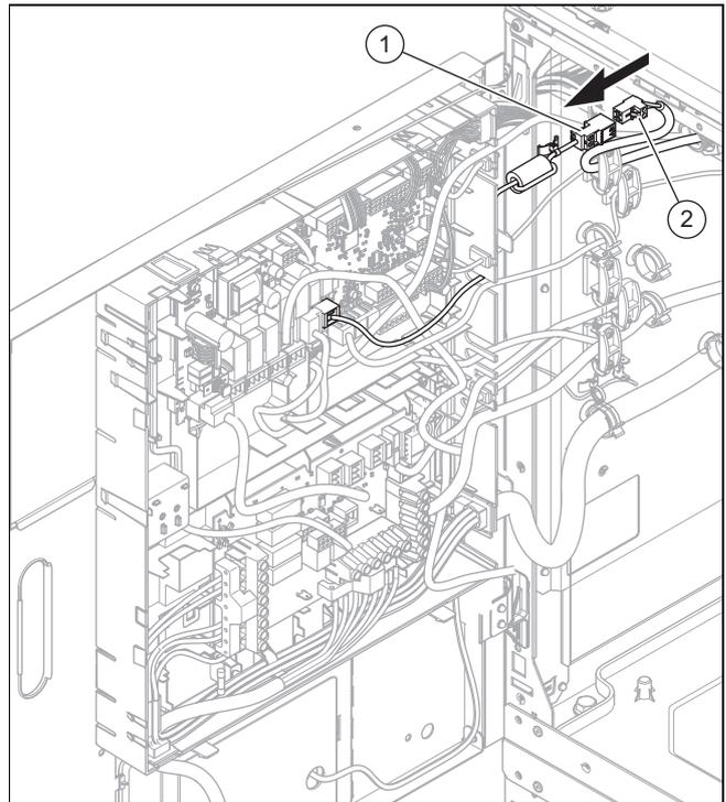
8. Inserire il connettore a spina Pro-E rosso (2) nella presa del cavo di collegamento Modbus (1) che esce dalla scatola della scheda comando.
