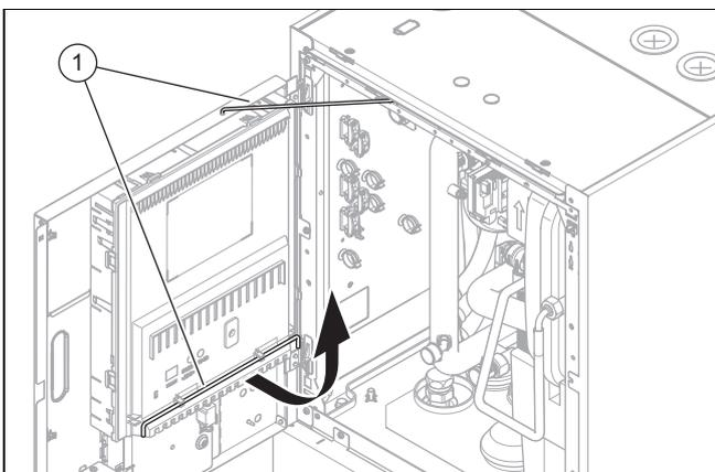
3. Fissare la scatola della scheda comando con l'asta di bloccaggio (1).
