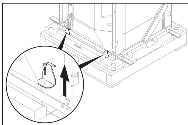
4. Per allentare il fissaggio del prodotto con il bancale, rimuovere i 4 avvitamenti sul lato anteriore e posteriore.
